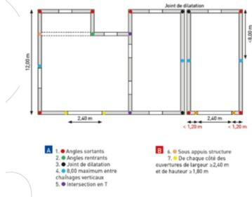
A NOTER - Dans tous les cas, le DTU et la réglementation sismique imposent la mise en œuvre d'une section minimale d'acier dans les chainages. La section minimale de la réglementation prime sur celle du DTU. Quel que soit le type d'élément de maçonnerie, il existe des accessoires permettant de réaliser les chainages et les points singuliers (quelle que soit la zone sismique).
