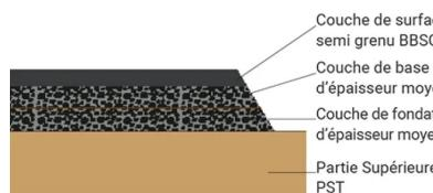
Figure 3. Profil en travers de la solution bitumineuse.
