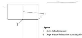
Exemple de positionnement des joints de fractionnement (source : NF D7U 26.2)
