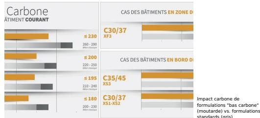
L'usage des formulations de béton bas carbone est un levier d'optimisation important. Cependant, il doit être déclenché lorsque les pistes d'optimisation précédentes ont déjà été déployées, et que le projet nécessite encore une réduction de l'impact du gros œuvre.
