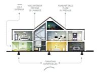
exemple d'optimisation des classes d'exposition du béto suivant si la façade est
