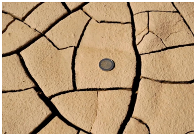
Forte sensibilité des matériaux loessiques : exemple d'une poche de matériau sec dans un dépôt après un épisode de forte chaleur.
