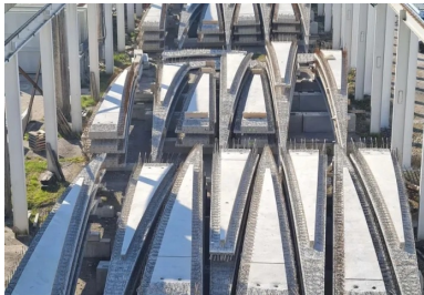
Stockage des « pétates » dans l'usine Capremib, filiale de Demathieu Bard spécialisée dans la préfabrication.
