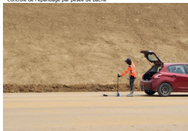
Contrôle du compactage à l'aide d'un gammadensimètre
