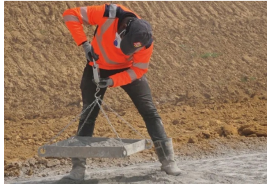
Contrôle de l'épandage par pesée de bâche
