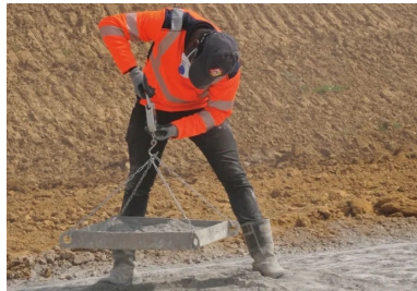
Contrôle de l'épandage par pesée de bache
