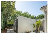
Les panneaux préfabriqués (MCII) en béton brut gris clair et les baies vitrées rythment la géométrie des façades, soulignée par le calepinage des joints verticaux et horizontaux.
