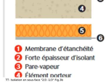
TT- Isolation en sous-face \*2/3 -1/3\* Fig.3b
