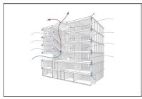
Principe de ventilation dans l'atrium et au niveau de la façade double peau
