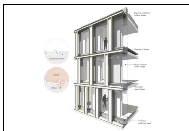
Façade double peau, clapet de ventilation en position fermée
