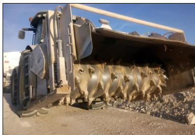
Vue du rotator du pulvimixeur de l'entreprise Brunner.
