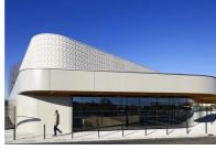
Le volume de la salle, visible en façades, est en béton gris très clair et présente un parement matricé. Au rez-dechaussée, les façades sont réalisées avec des éléments préfabriqués en usine de type murs à coffrage intégré. © Franck DELETANG
