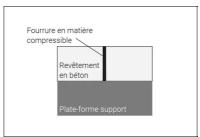
Schéma 3. Schéma d'un joint
