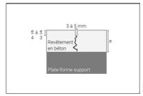
Schéma 1. Schéma d'un joint de retrait / flexion.
