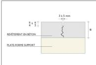
Schéma d'un joint de retrait-
