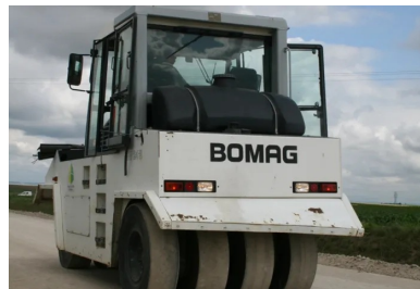
Compacteur à pneus en action.
