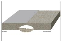
Illustration de la surface du béton avant et après le bouchardage.
