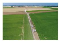
Vue aérienne du chantier de retraitement à froid au liant hydraulique routier de la RD36a, réalisé par la société Routes et chantiers moderne: (RCM), avec du Rolac Optimu de Saint-Pierre-la-Cour de LafarceHolim
