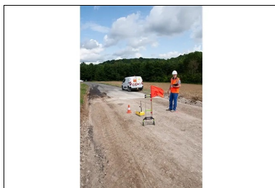
Contrôle de compactage au gamma-densimètre
