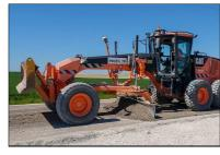
La niveleuse intervient après le V4 pour mettre au profil la surface du matériau.
