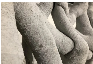
Béton extrudé dans une matrice de gel réutilisable - SoLiquid
