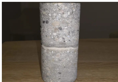
Éprouvette de béton intégrant la membrane SEPC.
