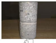
Eprouvette de béton intégrant la membrane SEPC.
