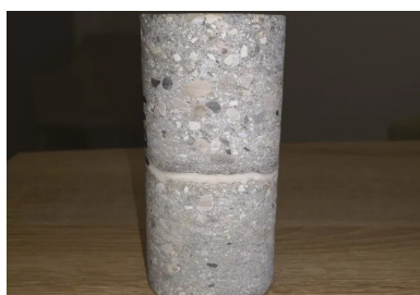
Éprouvette de béton intégrant la membrane SEPC.
