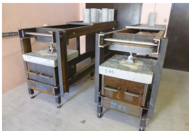
Essais de fluage par poinçonnement-flexion en cours sur les bâtis.
