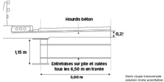
La dalle est coulée suivant un phasage classique de pianotage en 5 plots en commençant par les culées et se terminant par le dernier plot sur **pile** à l'aide d'un outil coffrant.
