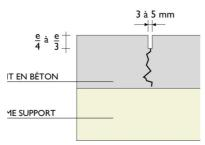
L'espacement optimal des joints dépend du retrait du béton, des caractéristiques de friction de l'infrastructure et de l'épaisseur du revêtement. Le transfert de charges aux droits des joints est d'autant mieux assuré que leur espacement est réduit. Toutefois, l'expérience et la pratique ont permis d'établir une
