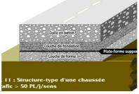
Dans le cas d'une chaussée neuve à faible trafic (trafic ≤ 50 PL/j/sens), la couche de fondation n'est pas nécessaire. La dalle en béton de ciment peut ainsi être réalisée directement sur l'arase terrassement (avec une couche de réglage éventuelle) ou sur la plate-forme support de chaussée (figure 12).
