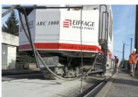
L'ARC® 1000 vu de face, avec sa chenille avant qui précède le rotor de 2 mètres de largeur
