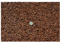
Perméable, avec un haut niveau d'absorption permettant de gérer les épisodes pluvieux exceptionnels (niveau de drainabilité pouvant atteindre 50 l/m2/s ou vitesse de percolation pouvant aller jusqu'à 5 cm/s).
