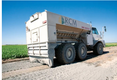
L'épandeur à liant de RCM.
