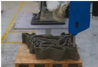
L'imprimante en action : la tête d'impression déverse peu à peu le béton, selon la numérisation des plans (Seahoost et XtreeE).
