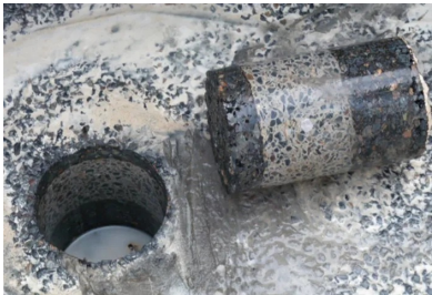
Carotte prélevée dans une chaussée composite illustrant parfaitement le collage BAC sur GB3.
