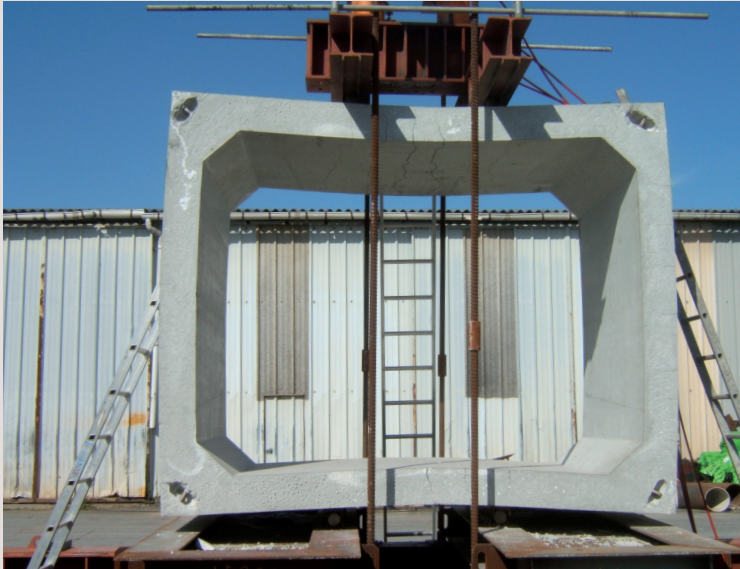
→ Essai de chargement, montrant la ductilité des éléments en béton armé de plats crantés.
