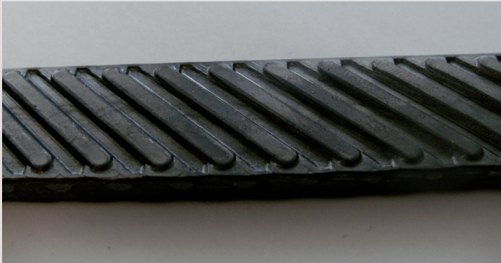
Fig. 1 – Adhérence de forme par la réalisation de verrous obtenus par laminage.
