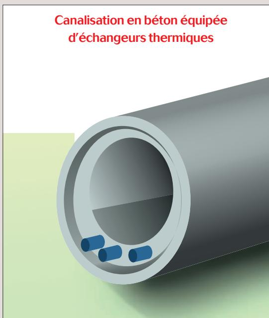
**Canalisation en béton équipée d'échangeurs thermiques**
