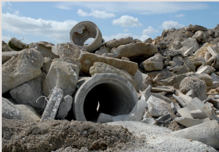
→ Stock de bétons de démolition avant traitement.
