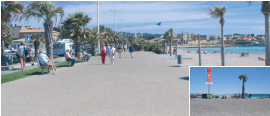
Six-Fours-les-Plages : la promenade Charles de Gaulle, traitée en béton désactivé, donne directement accès à la plage.
