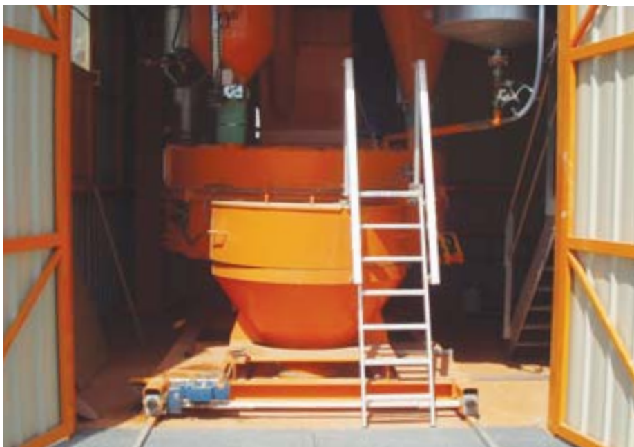
Chariot permettant l'échange rapide de malaxeur.
