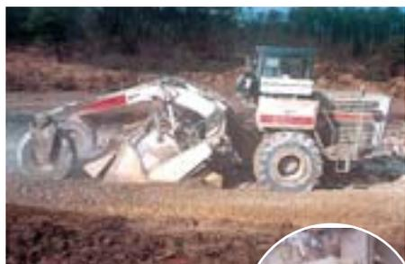
Le malaxeur de 650 CV assure un traitement homogène sur une profondeur de 35 cm.
