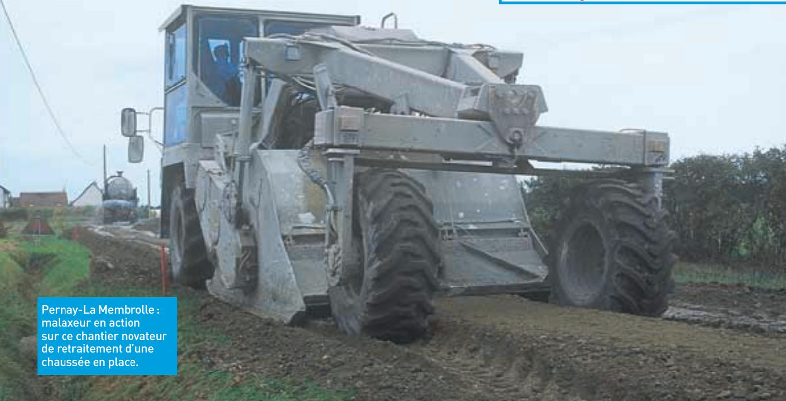
Pernay-La Membrolle : malaxeur en action sur ce chantier novateur de retraitement d'une chaussée en place.
