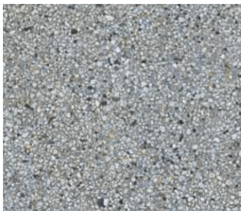
Le choix du traitement de surface et du granulat donne à l'exploitant la possibilité de moduler la perception sonore de la chaussée.
