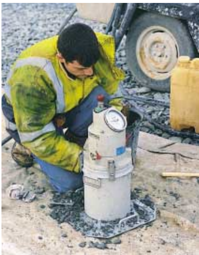
▲ Chaque jour, neuf éprouvettes sont réalisées pour les tests à 28 jours.
