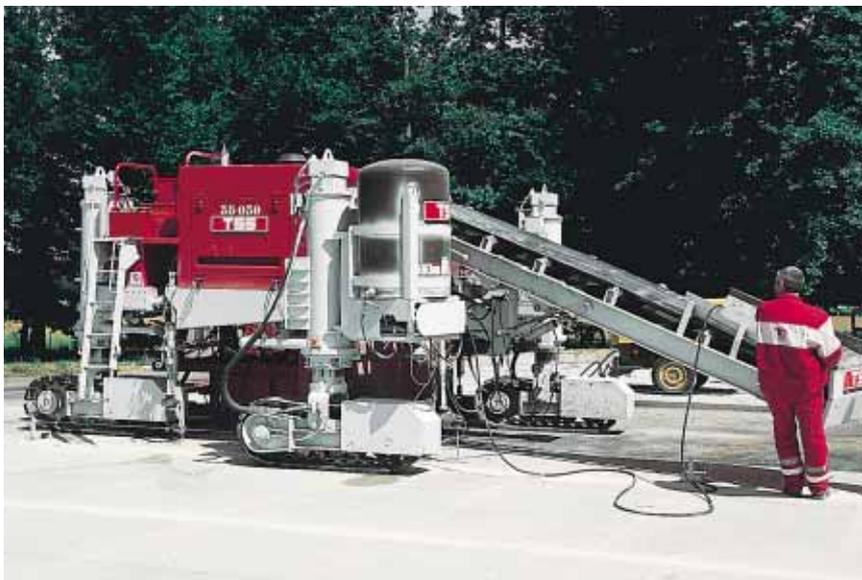
▲ Roulant en décalé sur trois chenilles, la slip-form peut réaliser les bandes bord à bord.
