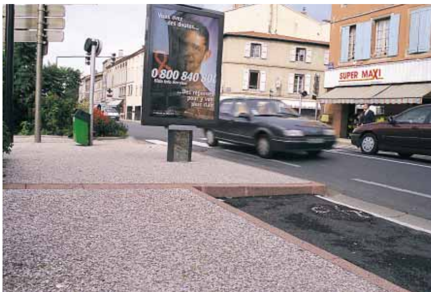
▲ Albi, avenue du Colonel-Teyssier : les trottoirs de cette avenue qui permet d'accéder au centre-ville ont été traités en béton désactivé pour répondre à un souci de qualité.
