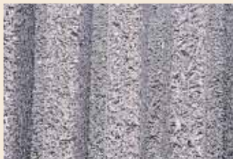
▲ La porosité du béton de bois, qui fait l'objet d'un suivi particulier lors de la fabrication, confère au matériau une très forte capacité d'absorption du bruit routier.
