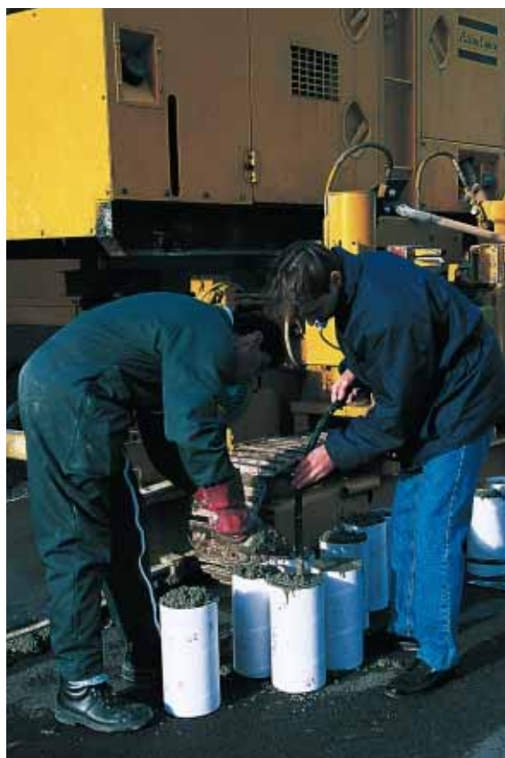
▲▼ La maîtrise de ce chantier expérimental a demandé des moyens de contrôle plus importants (prise de température du béton et réalisation de 18 éprouvettes au total).
