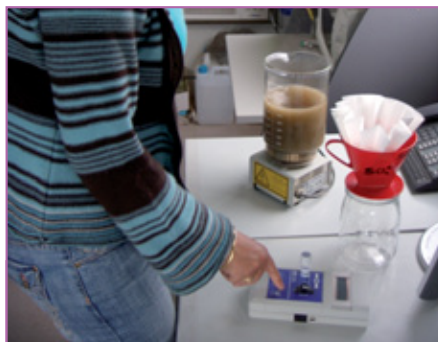
Toutes les 1 500 tonnes de matériaux recyclés, les centrales contrôlent les teneurs en sulfates solubles.
