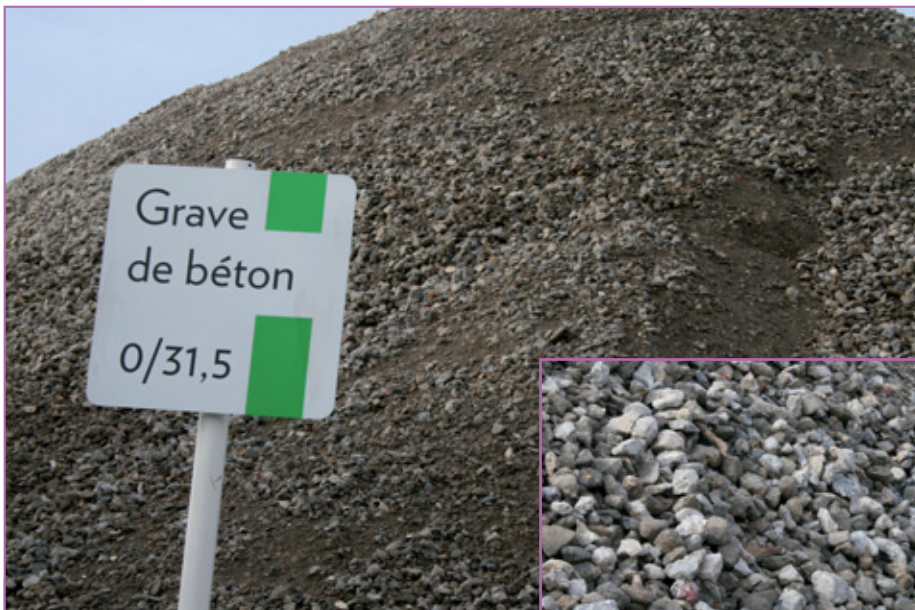
Le site de Gennevilliers réalise différentes graves de béton, comme celle-ci dont la granulométrie est de 0/31,5.
