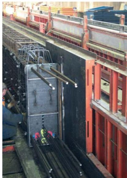
La mise en précontrainte des poutres est obtenue par relâchement des câbles : la tension dans les câbles se transmet par adhérence au béton et engendre, par réaction, sa mise en compression. Elle est possible dès que le béton atteint une résistance en compression de 30 MPa. Cette résistance est obtenue généralement dans un délai de l'ordre de 16 heures grâce à un système d'étuvage ou un traitement thermique adapté.
