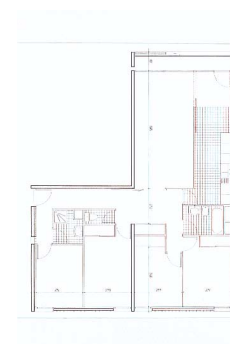
4 Quatre pièces traversant dans une trame de 6 m
