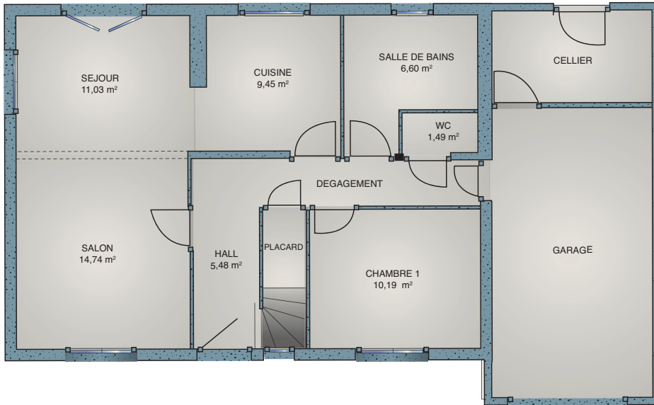
Figure 4 : plan du rez-de-chaussée d'une maison M12
