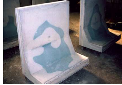
FIGURE 1 - Coloration bleu-vert observée sur des bétons contenant du laitier (à gauche, du BPE ; à droite, de la préfabrication)(© Eqiom)
