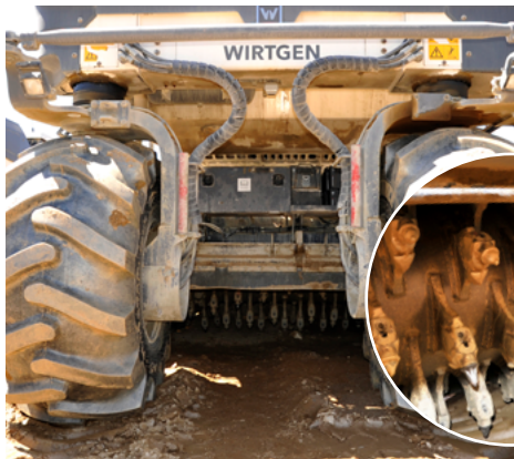
⬆ Un malaxeur Wirtgen WR 240i avec injection d'eau dans la cloche a permis le malaxage du matériau et du LHR.
