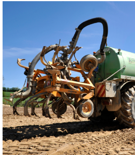
⬆ L'arroseuse à enfouissement garantit une teneur en eau optimale.
