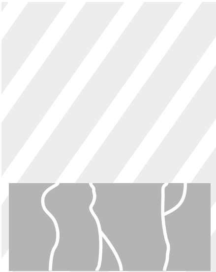
▲ Figure 1. Schéma illustrant le comportement d'un revêtement en béton exécuté sans armatures longitudinales et sans joints de retrait transversaux. Conséquences : fissuration large, anarchique et aléatoire.
